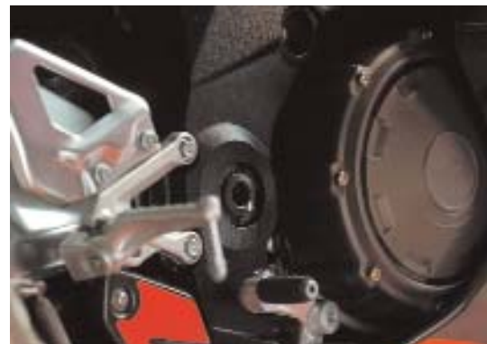
Магневая крышка КПП — одна из фишек, благодаря которой двигатель Magnesium получил свое название
