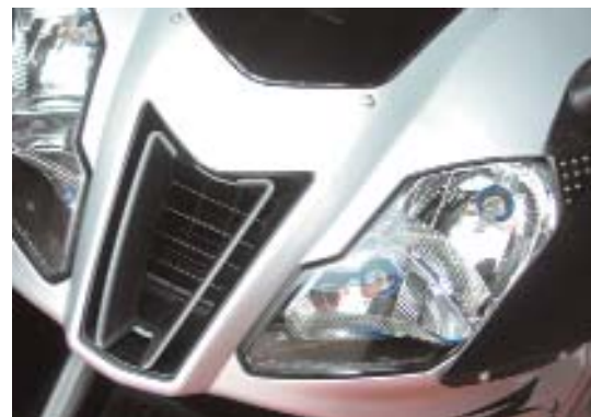
Система инерционного наддува — не дань моде, а путь получить 3-х процентный прирост мощности
