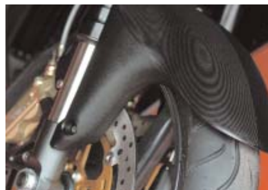
Карбон использован везде, где это только возможно. Переднее крыло так же участвует в борьбе за снижение веса
