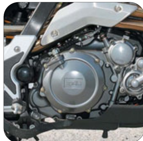
Силовой агрегат Rotax отлично зарекомендовал себя на предыдущих модификациях мотоцикла, а также на безызывном BMW F650GS. Благодаря системе электронного впрыска топлива, а также балансирующему валу, культура его работы и характеристики на высоте
