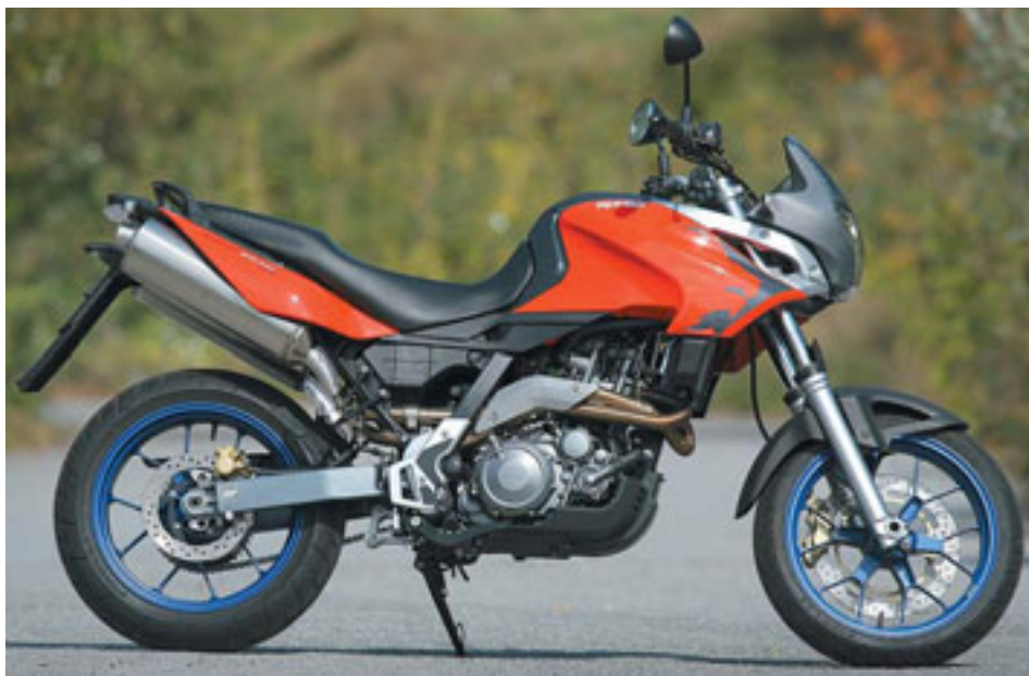
Силовой агрегат Rotax отлично зарекомендовал себя на предыдущих модификациях мотоцикла, а также на безызывном BMW F650GS. Благодаря системе электронного впрыска топлива, а также балансирующему валу, культура его работы и характеристики на высоте
