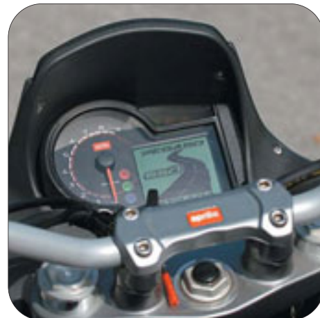
Приборная панель удивляет богатством функций. Счетчик кругов, настраиваемый сигнализатор переключения передач - все это уже в базовой комплектации!
